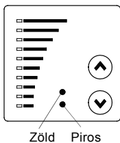
37. ábra Egyfázisú szivattyúk jelzőfényeinek elrendezése
